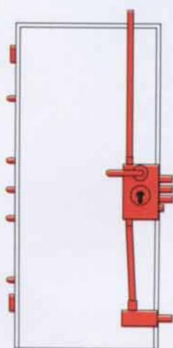
La serratura di sicurezza per cilindro a profilo europeo offre non solo eccellenti caratteristiche tecniche e funzionali, ma anche la praticità di una chiave di dimensioni ridotte.
