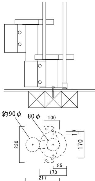
ボルト位置：下部固定板外径より17mm (ボルト口15mmφ)
